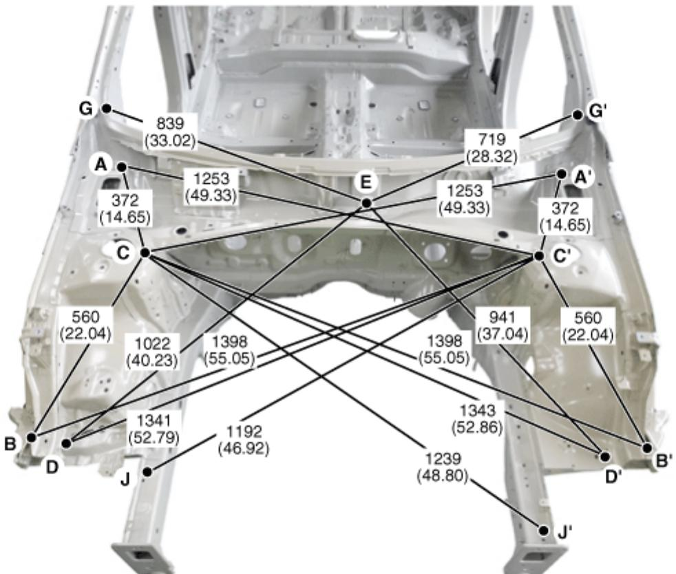
\*图中所示尺寸为实际测量尺寸。[单位: mm(inch)]
